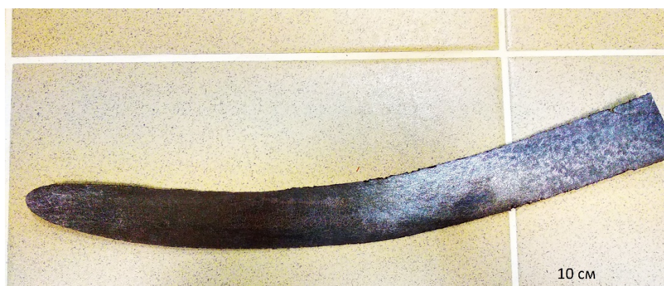
Рисунок 3.1.4.3 – Слиток сплава Ti-25Nb-5Ta после деформации при 600°C
