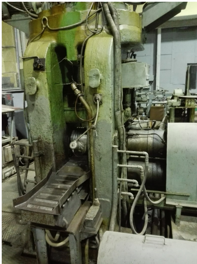
Рисунок 2.1.3.1 – Прокатный стан ДУО-300
