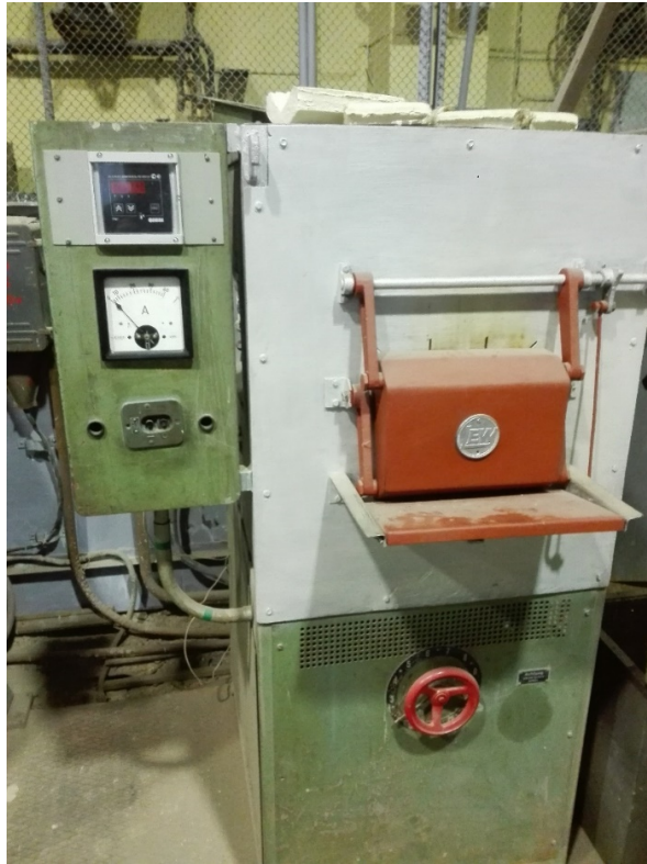
Рисунок 2.1.3.2 – Печь KYLS 20.18.40/10 фирмы Hans Weimler (Германия)
