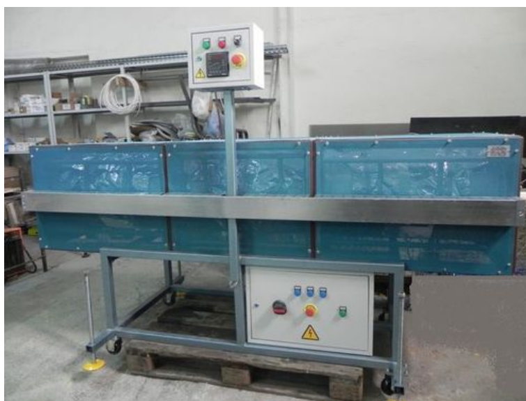
Рисунок 2.1.2.3 – Электропечь ПТС-2000-40-1200 фирмы "Лори-Термо" (Россия)
